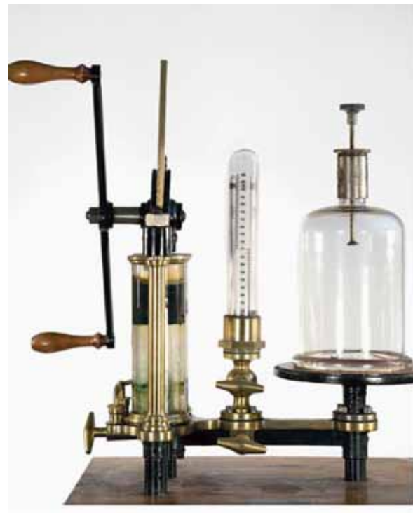
Вакуум помпа, 1890 г., Виена (A. Pichlers Witwe & Sohn), от колекцията на Национален музей на образованието „Училищни уреди и апарати“.
